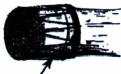
Buộc màng ngăn vào đầu ống dẫn nước hoặc ống thoát nước
