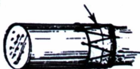
Buộc màng ngăn vào đầu ống dẫn nước hoặc ống thoát nước
